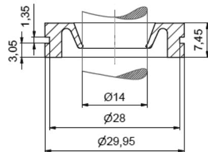
Die speziell von SEC gefertigten Wellendichtringe eignen sich perfekt für Anwendungen mit unseren VISEC Rotor-Units der R-Baureihe UR8 und UR10. Im Dichtungsgehäuse eingebaut, sorgen sie für einen reibungslosen Dosierablauf, ohne Undichtigkeiten.
